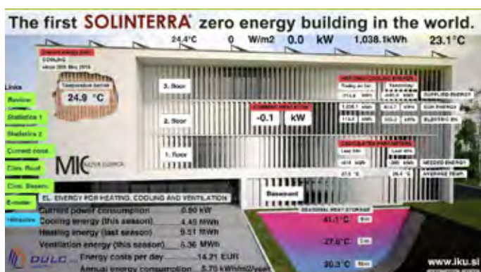
Prikaz delovanja nadzornega sistema v realnem času, ki skrbi za celotni sistem upravljanja tehničnih sistemov na stavbi
